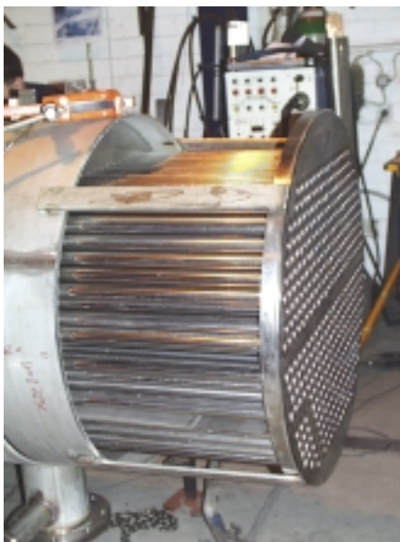
Rohrbündelwärmetauscher des Dampferzeugers. (Bild: apaco)
