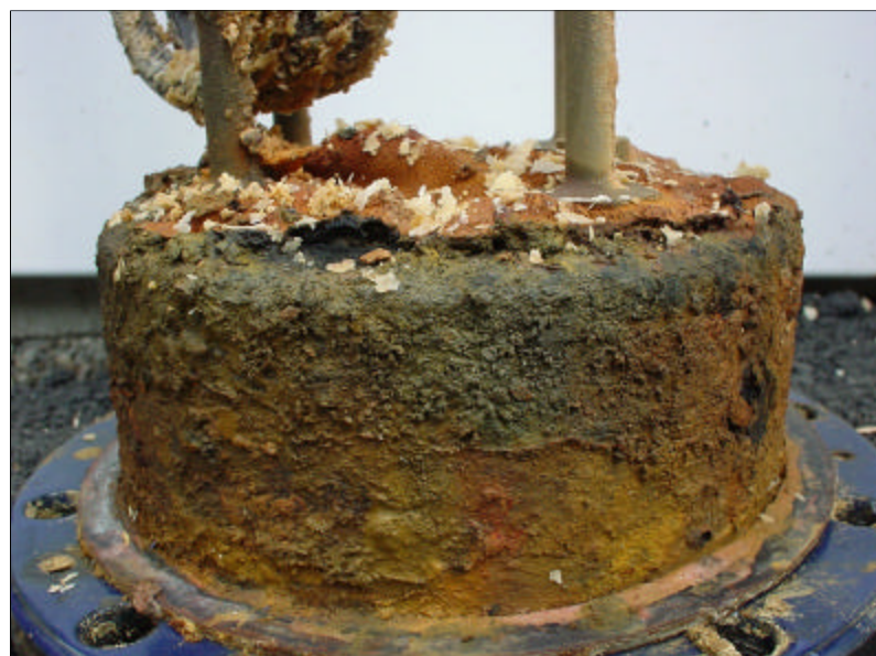
Abb. 2: Durchgerosteter Heizstab eines Wassererwärmers (Quelle: Tanner Wasseraufbereitung, Reigoldswil)
